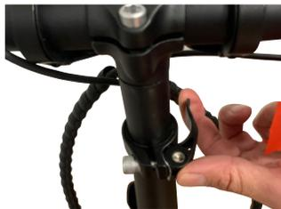
4. Vorbau falten und Oberteil herausziehen bis Bremshebel und Griffe am Rahmen vorbeikommen (ca. so weit bis Unterkante Oberteil in Klemmung sichtbar) auf freigängigkeit der Züge achten
