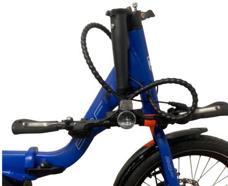
5. Sicherung Rahmenscharnier öffnen und Hebel umlegen
